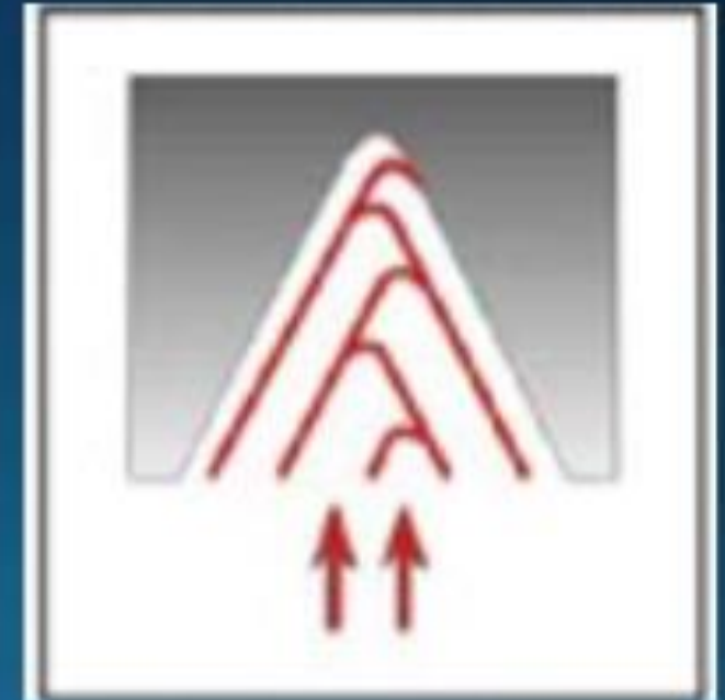
Gambar 3 Metoda pematangan ulir dengan cara zig-zag
